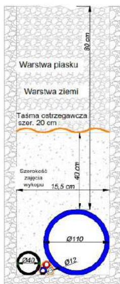
Przekrój wykopu otwartego z planowanym ułożeniem rur
